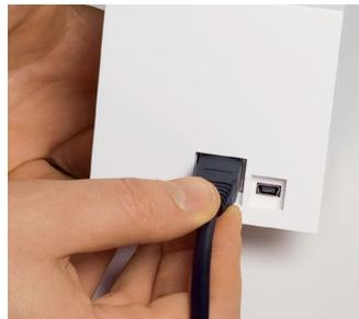
**Bild 2:** Stecken Sie das RJ45-Netzwerkkabel in die Buchse auf der Rückseite des Cubes.
