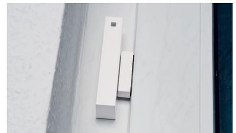
**Bild 12:** Der Fensterkontakt ist nun bereit für das Anlernen an den Cube. Die Kappe darf erst nach dem Anlernvorgang aufgesetzt werden, da die Taste zum Anlernen innen liegt.
