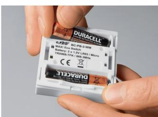
**Bild 13:** Entfernen Sie die Montageplatte und legen Sie die mitgelieferten Batterien polrichtig in den Taster ein.
