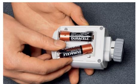
**Bild 7:** Legen Sie nun die mitgelieferten Batterien polrichtig in den MAX!-Heizkörperthermostat ein.
