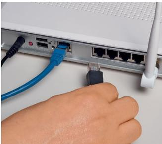
**Bild 1:** Verbinden Sie den Cube über das mitgelieferte RJ45-Netzwerkkabel mit einem freien Port an Ihrem Router.
