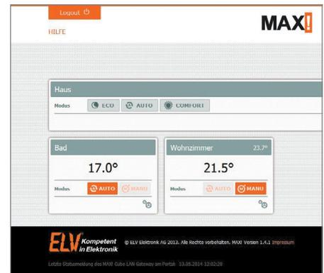
**Bild 30:** Auf das MAX!-Internet-Portal können Sie nun jederzeit mit einem internetfähigen PC zugreifen und Heizprofile verändern. Das Anlernen neuer Komponenten ist an dieser Stelle nicht möglich.
