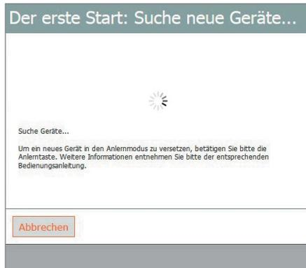
**Bild 20:** Suchen Sie nun nach den zuvor installierten MAX!-Komponenten. Versetzen Sie die MAX!-Komponenten dafür in den Anlernmodus (siehe Anweisungen in den Bedienungsanleitungen).
