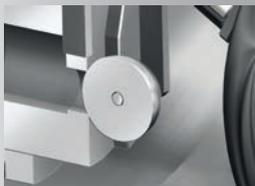
Abschlussorgan des Ableitermechanismus mit Rollkugel zum sicheren Absperren der Förderleitung.
