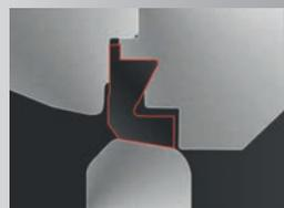
Dicht schließend bis max. +180°C durch PTFE-Dichtring.
