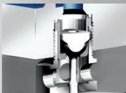
Langlebiges, doppelt geführtes Treibdampfventil mit Kantensitz – zum sicheren Abschluss der Treibdampfleitung.
