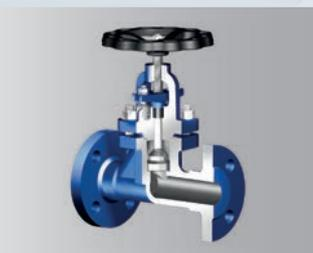
Wirtschaftlichkeit: „Two-in-One“ (loser Kegel mit Rückstellfeder – dadurch zusätzliche Funktion als absperbares Rückschlagventil).
