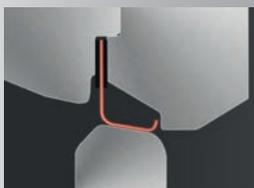
Dicht schließend bis max. +260°C durch metallischen Dichtring.
