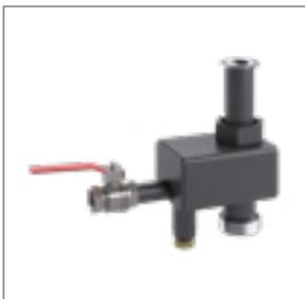
Die Wartungsbox, passend für alle Kleinverteiler 80/60, als optionales Zubehör zur Magnetitabscheidung mit G 1 1/2" Anschlüssen. Bestehend aus Profiltröhr 80x60, Material S235, Anschluss: 2x G 1 1/2". Versehen mit Entschlammungsstutzen und Kugelhahn 1/2" sowie in Tauchhülse eingeschraubtem Magnetstab. Zur Anbringung am Kesselrücklauf unter dem Verteiler. Ermöglicht eine Entschlammung bei druckbehafteter Anlage. Inkl. EPP-Dämmung nach EnEV.
