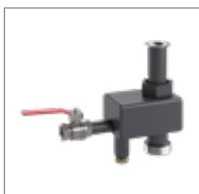
Die Wartungsbox, passend für alle Kleinverteiler 120/80, als optionales Zubehör zur Magnetitabscheidung mit 1x oben Rp 2", 1x unten R 2" Anschlüssen. Bestehend aus Profilrohr 120/80, Material S235, Anschluss: 1x oben Rp 2", 1x unten R 2". Versehen mit Entschlammungsstutzen und Kugelhahn ½" sowie in Tauchhülse eingeschraubtem Magnetstab. Zur Anbringung am Kesselrücklauf unter dem Verteiler. Ermöglicht eine Entschlammung bei druckbehafteter Anlage. Inkl. EPP-Dämmung nach EnEV.
