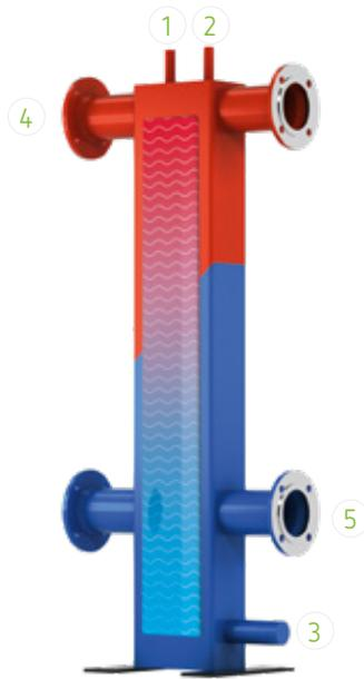
Das Grundprinzip einer Hydraulischen Weiche beruht auf der thermischen Schichtung, wonach sich das warme Wasser (geringe Dichte) im oberen Bereich sammelt und das kalte Wasser (hohe Dichte) im unteren Bereich.
